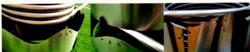
Устанавливайте спираль таким образом, чтобы нижний прямой участок трубы попал в максимальный вырез в подставке.
